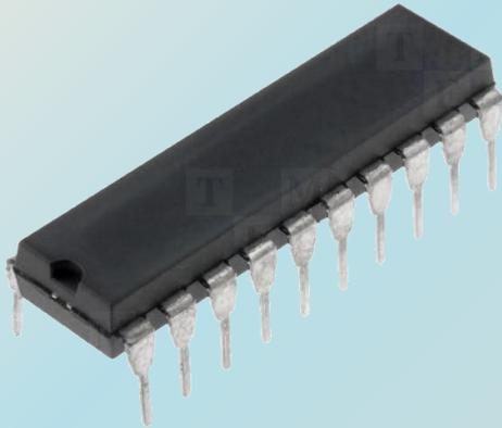
Микроэлектронное устройство произвольной сложности (кристалл), изготовленная на полупроводниковой подложке и помещённая в неразборный корпус или без такового.
